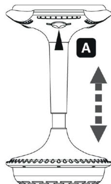
Pour abaisser le siège, appuyez sur l'un des 3 boutons situés sous le siège en position assise.
