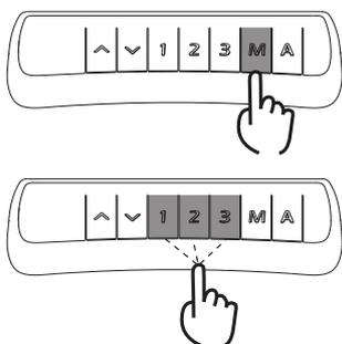
a. Benutzen Sie die Auf- und Ab-Taste, um die Höhe der Tischplatte auf die gewünschte Höhe einzustellen, drücken Sie die Speichertaste "M", auf dem Display erscheint "5-", dann drücken Sie die Taste "1", "2" oder "3", um die Höhe zu Position 1, 2 oder 3 zu speichern. Auf dem Display wird die entsprechende Anzeige "5-1", "5-2" oder "5-3" angezeigt.
